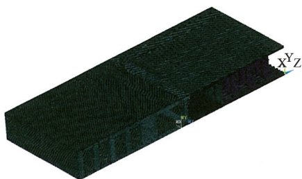
图 5 钢混结合段的有限元模型
